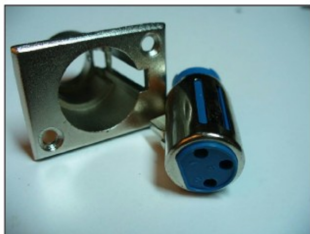
Figura 2 – Canhão da ficha XLR retirado
