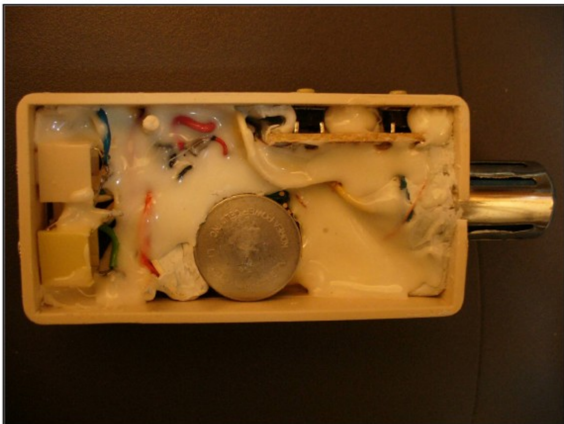
Figura 10 – Caixa cheia a cola endurecida.
