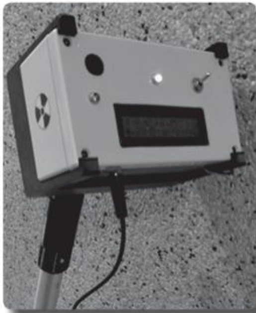
Figura - 3: Estrutura de suporte feita em 3D para uso em punho e de adaptação à canadiana
