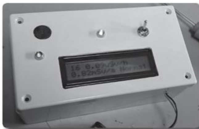
Figura - 2: As leituras são: CPM = 16 => 0,090 uSv/h => 0,82 mSv/Ano => Normal
